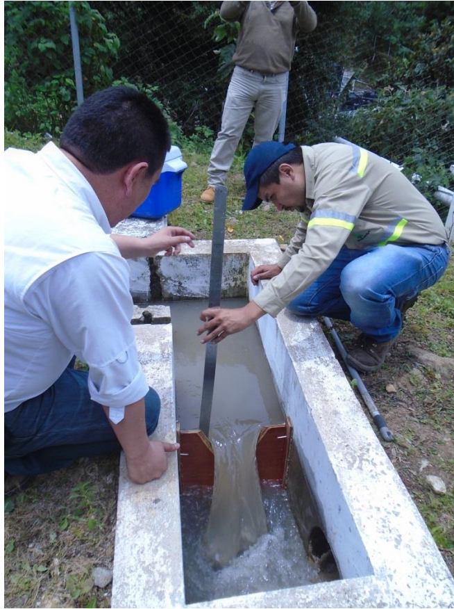
Aforo en planta de tratamiento de aguas residuales
